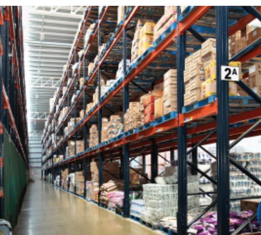
Les tours de préparation de commandes permettent de stocker un total de total 1 908 palettes dans les rayonnages dynamiques et 2 840 palettes dans les rayonnages push-back, ainsi que 40 700 caisses carton
