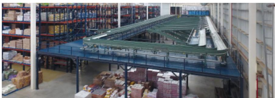
**4. Entrepôt Pallet Shuttle :** deux niveaux de rayonnages par accumulation avec le système Pallet Shuttle semi-automatique ont été installés sur une mezzanine industrielle située devant les quais de chargement. Leur capacité est de 512 palettes de produits à forte rotation (type A).
