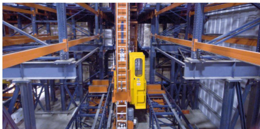
Les opérations sont réalisées avec des palettes de type périmétrique (possédant des patins sur les quatre côtés), des traverses perpendiculaires aux lisses des rayonnages ont été posées pour appuyer les palettes et s'assurer ainsi que les transstockeurs les manipulent en toute sécurité. Ce type de palettes contribue à améliorer la stabilité au moment de les remonter.
