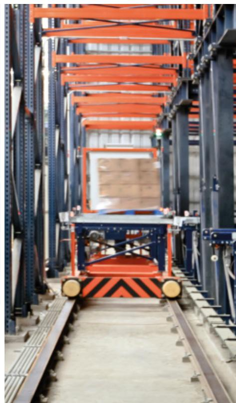
Les transstockeurs sont de type bicolonne et intègrent, dans leur nacelle de levage, une cabine pour la maintenance
