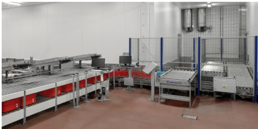
Au préalable, les produits sont introduits dans des bacs plastiques – type eurocaisses – de 600 x 400 x 300 mm, pour composer une unité de transport et de stockage
