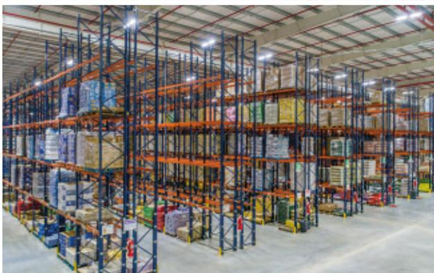
Mecalux a équipé le nouveau centre de distribution de CBN Group dans la province de Buenos Aires (Argentine) d'un système de rayonnages à palettes qui admet 41 659 palettes. L'entrepôt dispose d'une méthode de préparation de commandes efficace pour fournir ses clients dans les plus brefs délais.
