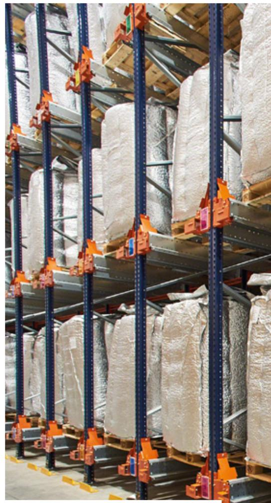
Les châssis des rayonnages sont plus robustes afin d'absorber les forces dynamiques provoquées par d'éventuelles secousses sismiques
