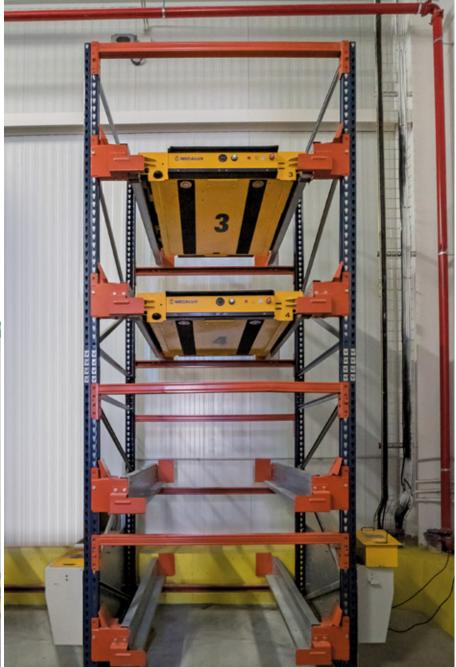
Les rayonnages par accumulation drive-in installés dans les trois chambres de congélation offrent une capacité de stockage supérieure à 3 400 palettes contenant les produits à plus forte rotation
