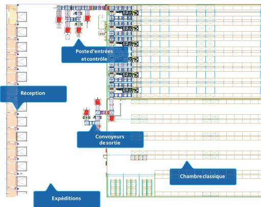
Les opérations dans la chambre froide autoportante sont totalement automatiques et sa capacité de stockage dépasse les 16 000 palettes
