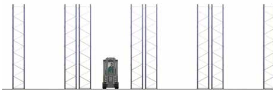
Palettier composé d'un rayonnage simple adossé au mur et de rayonnages doubles
